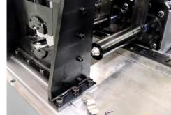
Cambio rápido de útiles En los modelos MB las estaciones de conformado Cambio de útiles de estaciones de conformado y mordazas de forma rápida y sencilla.
