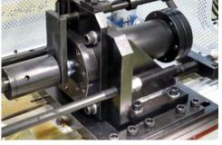
Ajuste 3D de la estación de conformado són adjustable en los ejes X, Y y Z.
